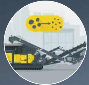
Procesamiento de material en ciclo cerrado – criba de cubierta de malla con cinta de retorno integrada y separador neumático opcional. Grano final clasificado en un sólo paso
