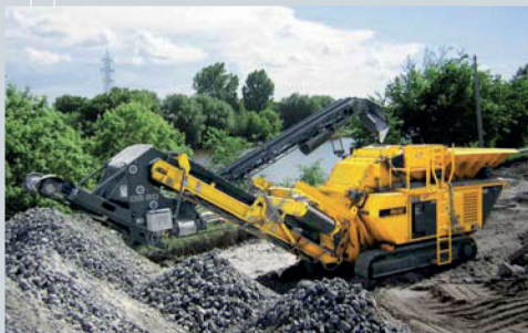
Grano final definido en un único paso, en circuito cerrado, con sólo un operador
