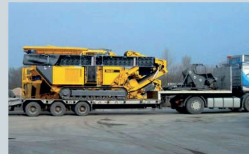
La movilidad beneficia: la trituradora (con la cinta de retorno) y el OS80 se transportan en un solo vehículo
