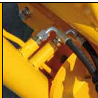
Conductos oleodinámicos para levantamiento de la cuchara
