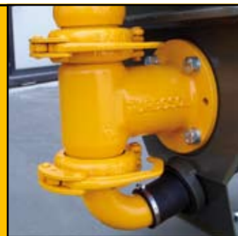
Rápido desmontaje del grupo bomba
