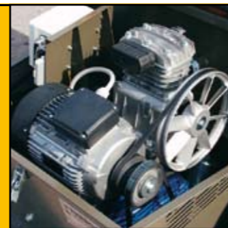
Compartimiento motor - compresor
