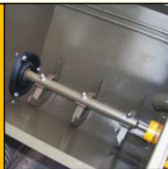
Vástago porta pistón con agitador
